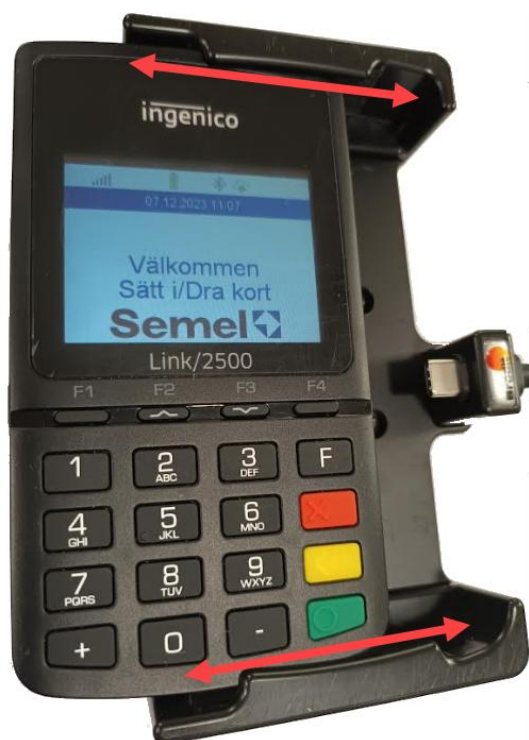
Bilde 5 Tilkobling til ladestasjon
