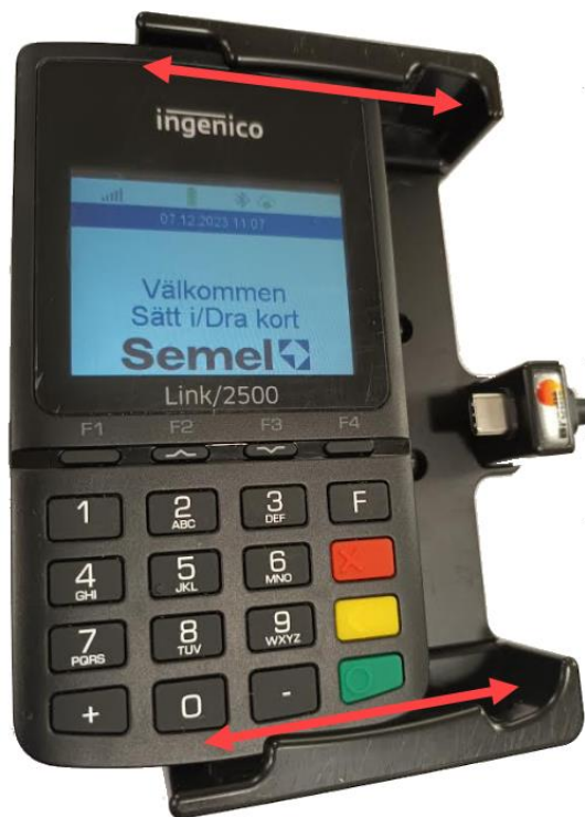
Bilde 5 Tilkobling til ladestasjon
